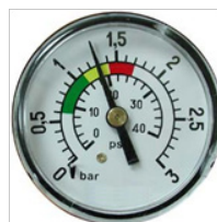
11,3 kg/cm 2 : A pressão é 0,5 kg/cm 2 superior à inicial, isto indica que é necessário efetuar a LAVAGEM
