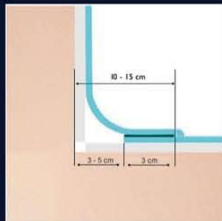
При сварке швов в углах следует оставлять припуск около 15 см для удобства сварных работ. Необходимо оставлять зазор (3-5 см) между мембраной и чашей бассейна в углах. Отступы расправятся при наполнении бассейна водой, что позволит избежать образования складок на мембране. Швы дополнительно обрабатываются жидким ПВХ-герметиком.
