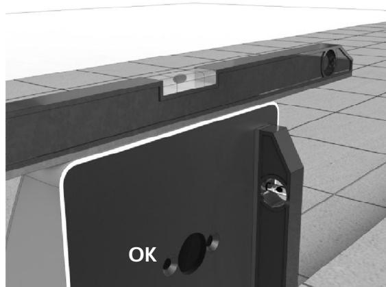
**Cuidado!:** Si se fuerza los pies para nivelarlos por las tuercas de fijación se puede dañar, incluso romper la parte trasera del motorreductor.
