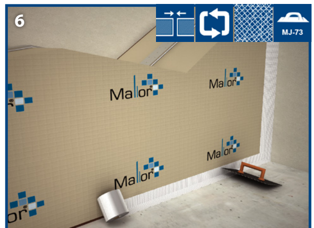
6 Aplicar la cinta de fibra de vidrio MALLOR (ref. 1010) y mortero para juntas MALLOR MJ-73 (ref. 1052) en todo el perímetro y uniones. Apply MALLOR fiberglass tape (ref. 1010) and mortar joint MALLOR MJ-73 (ref. 1052) along the perimeter and joints. Appliquer le ruban de fibre de verre MALLOR (réf. 1010) et le joint de mortier MALLOR MJ-73 (réf. 1052) le long du périmètre et des articulations.
