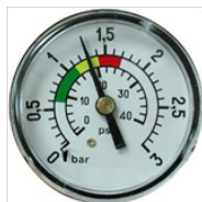
1,3 kg/cm 2 : La presión es 0,5 kgs/cm 2 superior a la inicial, esto indica que es necesario proceder al LAVADO
