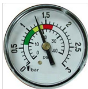
1,3 kg/cm 2 : La pression est 0,5 kg/cm 2 supérieure à la pression initiale, cela signifie qu'il faut procéder au LAVAGE
