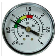
0,8 kg/cm 2 : Pression initiale d'un filtre au début d'un cycle de filtration
