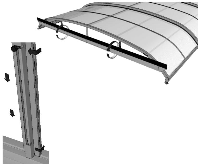
➤ FERMETURE ET FIXATION DE L'ABRI / CLOSE AND FIXING COVER / CIERRE Y FIJACIÓN DE LA CUBIERTA
