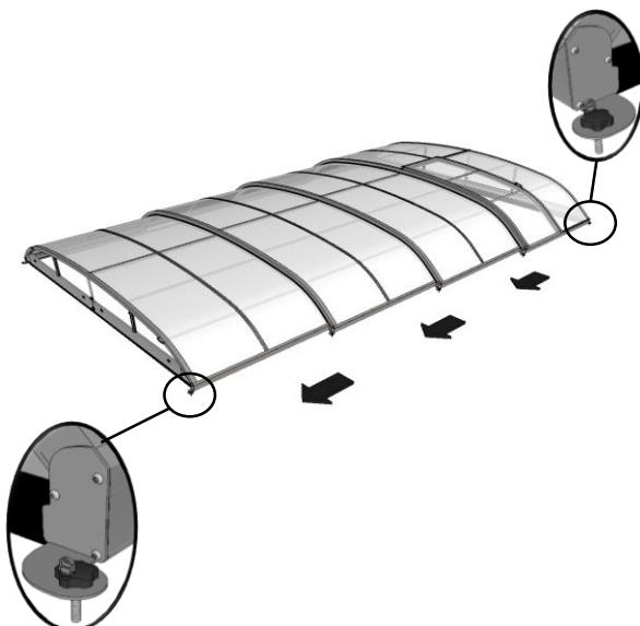
2. Chaque élément est équipé d'une paire de fixations positionnées de chaque côté afin d'ancrer le module au sol.
