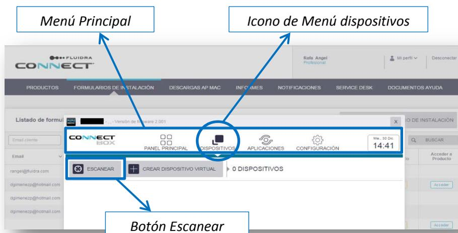
Ilustración 16: Pantalla de la Connect Box
